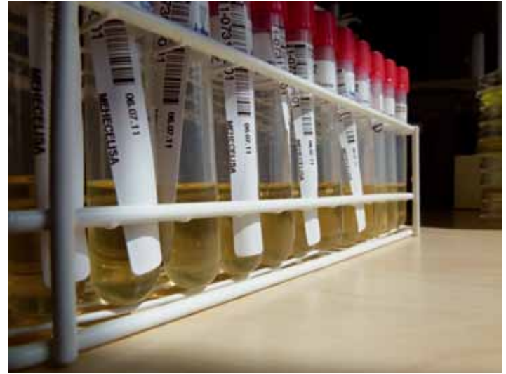
Abb. 4: Nach dem ersten Anreicherungsschritt erfolgt in einer erneuten Nährlösung, welche die Toxin-Produktion des EHEC-Keims anregen soll, eine weitere, 16-stündige Inkubation.
