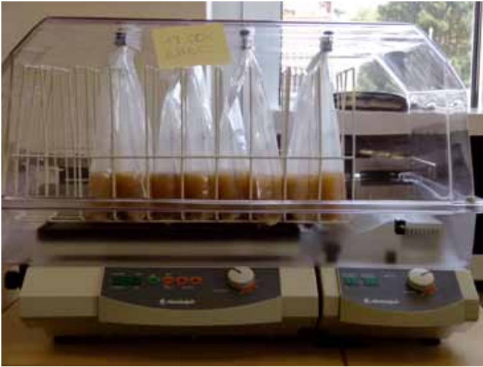
Abb. 3: Im Rahmen der Vorbereitung für den ELISA-Test auf EHEC müssen die entnommenen Lebensmittelproben in einer Nährlösung für sechs Stunden bei 37°C angesetzt werden. Die Bouillon fördert das Wachstum des EHEC-Erregers.
