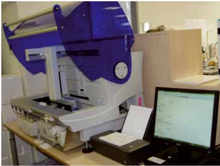
Abb. 5: Erst nach diesen beiden Anreicherungs-schritten kann die eigentliche Analyse mittels der immunologischen ELISA-Methode erfolgen, wo das von EHEC produzierte Toxin anhand eines immunologischen Tests nachgewiesen wird. Nach weiteren vier Stunden liegt dann das endgültige Ergebnis vor.
