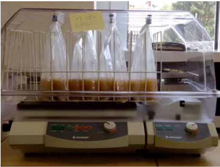
Abb. 3: Im Rahmen der Vorbereitung für den ELISA-Test auf EHEC müssen die entnommenen Lebensmittelproben in einer Nährlösung für sechs Stunden bei 37°C angesetzt werden. Die Bouillon fördert das Wachstum des EHEC-Erregers.
